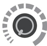
**Regulador Analógico de Temperatura:** es un termostato convencional que permite regular la potencia de las resistencias del asiento térmico del **TDBA**. Hacia la derecha del usuario se aumenta la potencia, hacia la izquierda se disminuye,
